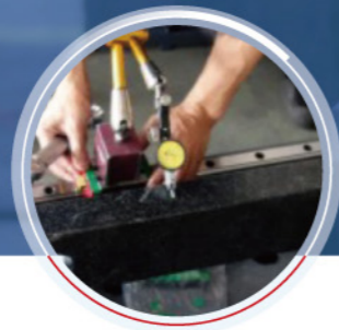
2 三轴导轨检验校正
